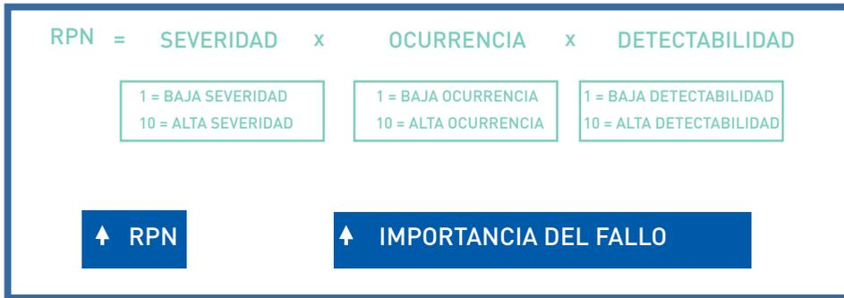
Figura 3. Proceso de cálculo del índice de riesgo prioridad. otro tipo, cuyo cumplimiento o adaptación, podrían evitar el fallo.
